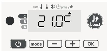
Augmentez de 2°C la température mesurée par la sonde à l'aide de la touche **+**.
