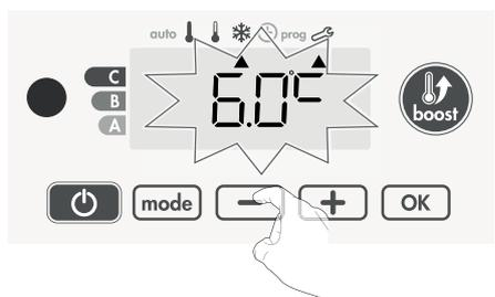
6- Pour valider et passer au réglage suivant, appuyez sur **OK**.
